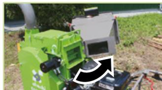
Ouverture trémie pour maintenance du moteur
