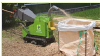
La goulotte avec ventilation déverse rapidement les copeaux dans un camion, sac ou au sol.
