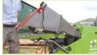
Permet d'arrêter le rouleau ameneur en cas d'urgence et si nécessaire sans les mains.
