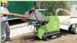
La goulotte à ventilation forcée déverse rapidement et directement les copeaux dans un camion ou dans un sac souple.
