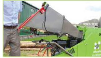
Permet d'arrêter le rouleau d'alimentation en cas d'urgence et, si nécessaire, sans se servir des mains.
