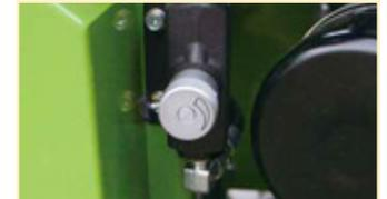
La vitesse de broyage peut être réglée en tournant le bouton du régulateur de débit. Permet d'ajuster la taille des copeaux.
