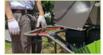
La poignée de frein est serrée pour le transport de la machine. Une fois desserré, le frein de stationnement est activé automatiquement.
