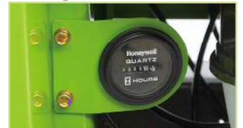
Machine équipée d'un compteur d'heures.
