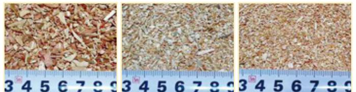
Pour ajuster la taille des copeaux et produire des copeaux de taille uniforme, il suffit de changer de tamis.
