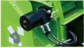
Un système de contrôle hydraulique sans fatigue automatique communique avec le rouleau d'alimentation pour s'assurer de la stabilité et de l'efficacité de l'alimentation en matériaux.
